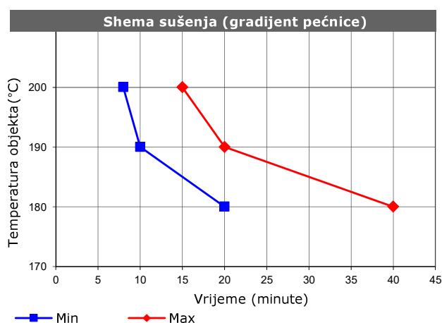
Komentar: Rezultati gradijenta pećnice mogu se razlikovati od industrijske primjene i dati su samo kao smjernice. Razlika sjaja i nijanse ovisi dosta o vrsti pećnice. Za plinske peći s izravnim plamenom kontaktirajte nas. Izbjegavajte nagle poraste temperature.
