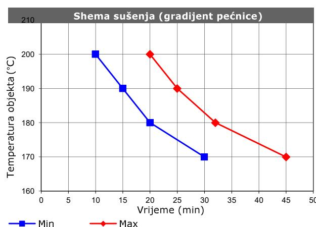
Komentar: Rezultati gradijenta pećnice mogu se razlikovati od industrijske primjene i dati su samo kao smjernice. Razlika sjaja i nijanse ovisi dosta o vrsti pećnice. Za plinske peći s izravnim plamenom kontaktirajte nas. Izbjegavajte nagle poraste temperature.
